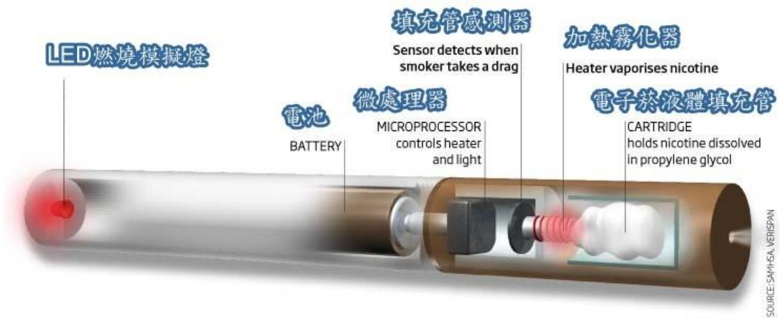
圖 1 電子煙零組件構造圖 。(<http://www.e-cigarettesdirect.com/pages/How-E-Cigs-Work.html>)
